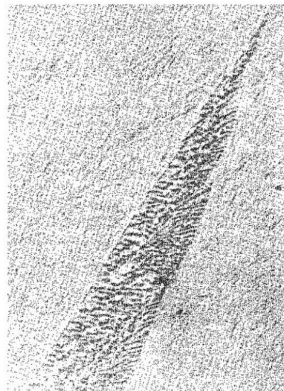
شکل ۳-۱۹ بینیت پایینی در فولاد ساده کربنی با ۰/۶۹ درصد کربن. ریزساختار الکترونی [۱۴].
